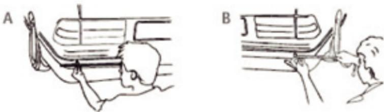
a. Elija la posición adecuada para taladrar los huecos de los sensores de las esquinas, márkuela. Para obtener el mejor ángulo de detección, la posición para los sensores de las esquinas debe estar a una distancia entre 8 y 11 cm de la esquina del bumper; se recomienda 11cm, 20° cerca del lado.
